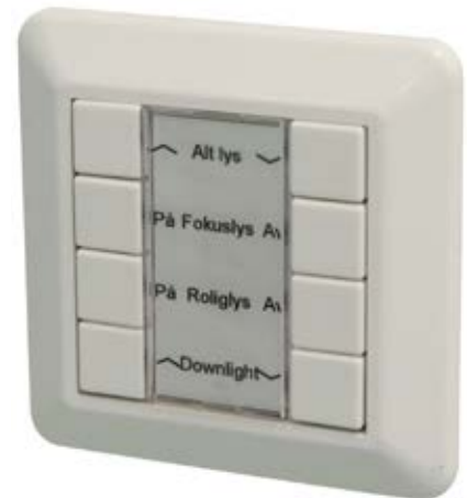
Figur 5. Bryterpanel hvor lærer og elev kan velge fokuslys og roliglys. Begge innstillingene går automatisk tilbake til vanlig lys etter 30 minutter, for å unngå for mye eller lite lys i store deler av skoledagen. Myke overganger mellom innstillingene er viktig. Foto: Glamox
